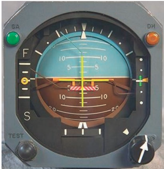
Figura 3 - Horizonte Artificial mecânico de uma aeronave. Fonte: Wikipedia: Wikimedia: Reddy & Garcia: NASA, 1996 (Imagem de Domínio Público).
